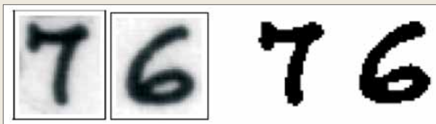
Figura 1. Imágenes antes y después de un filtro de binarización
